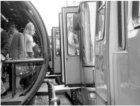
写真10 バスの高さチューブステーションの高さが同じ
