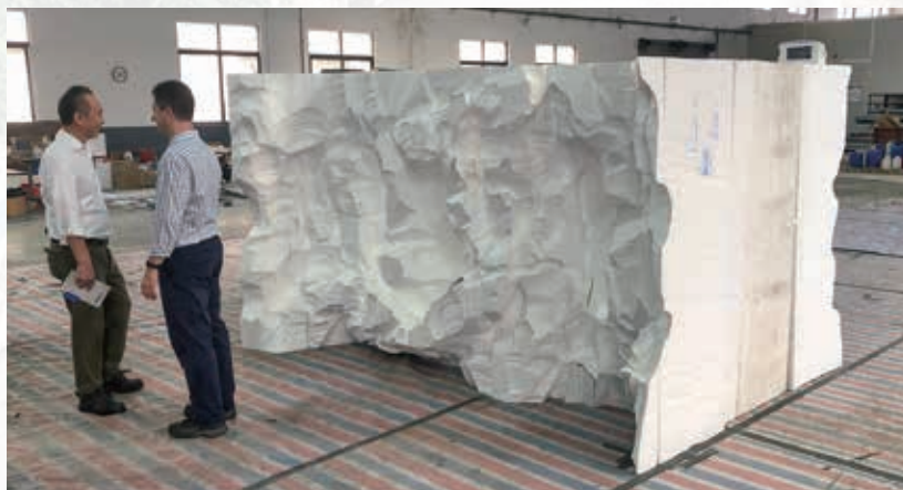
↑擬岩の型は削った発泡スチロール
