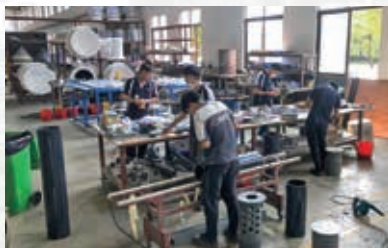
↑濾過槽の組み立て作業
