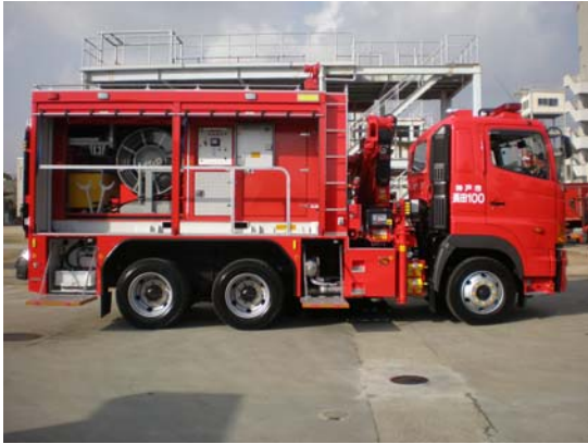
大容量ポンプ車
