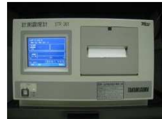
地震計(運転指令区)
