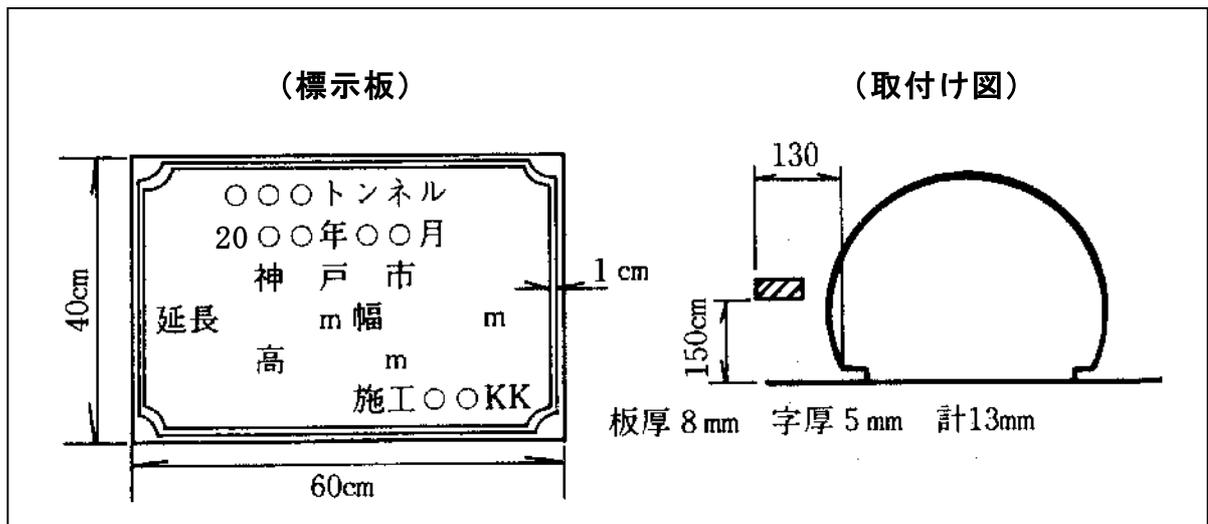
図6-2 標示板の設置イメージ図
