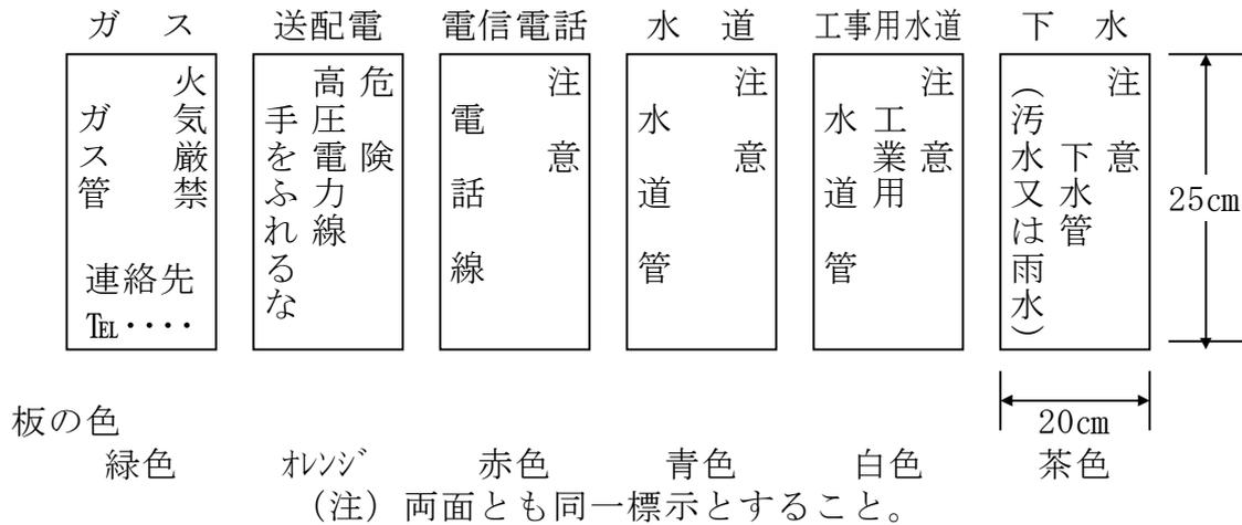
図1-2 露出する埋設物の標示板
