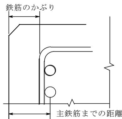
図3-1 鉄筋のかぶり
